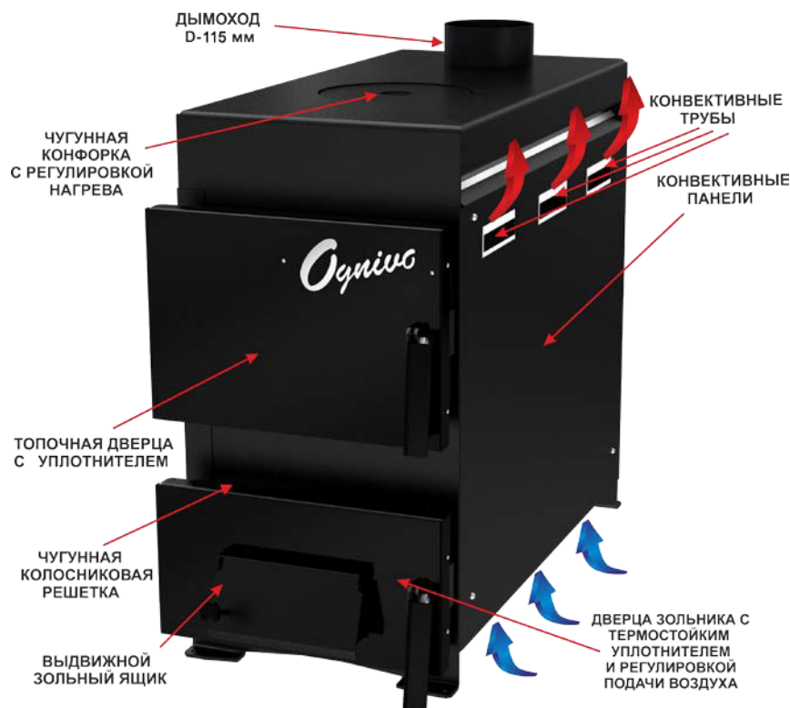
Рис. 2 Устройство печи OGNIVO Uglya
